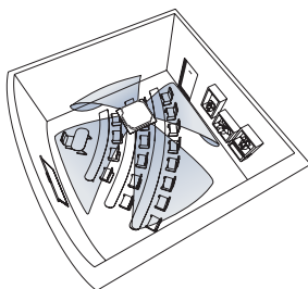
Направление всех четырёх воздушных потоков из кассетного блока можно синхронно менять по вертикали.
